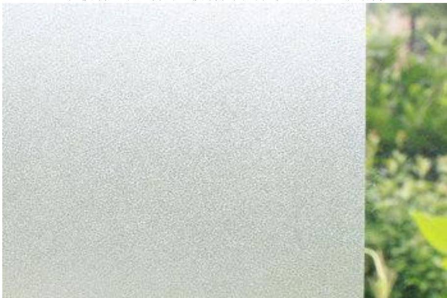
磨砂玻璃不透明，在玻璃两面磨出颗粒状，形成二级结构
